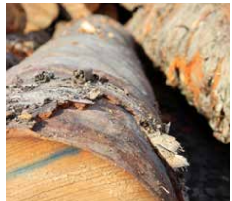
Fil du bois ondulé acceptable (reconnaisable à l'ondulation en surface)
