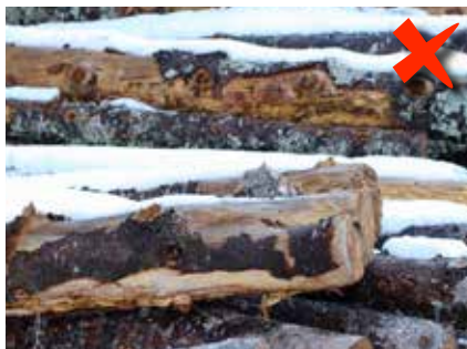
Bois dégradé (écorce décollée)
